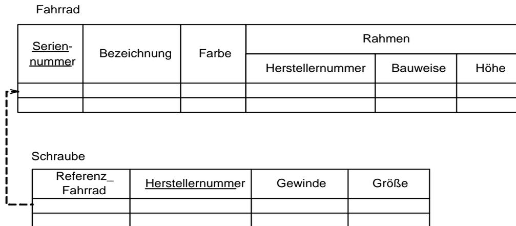
**Abbildung 3.84: Objekt-relationales Modell - Aggregation aufgelöst nach Variante II**
