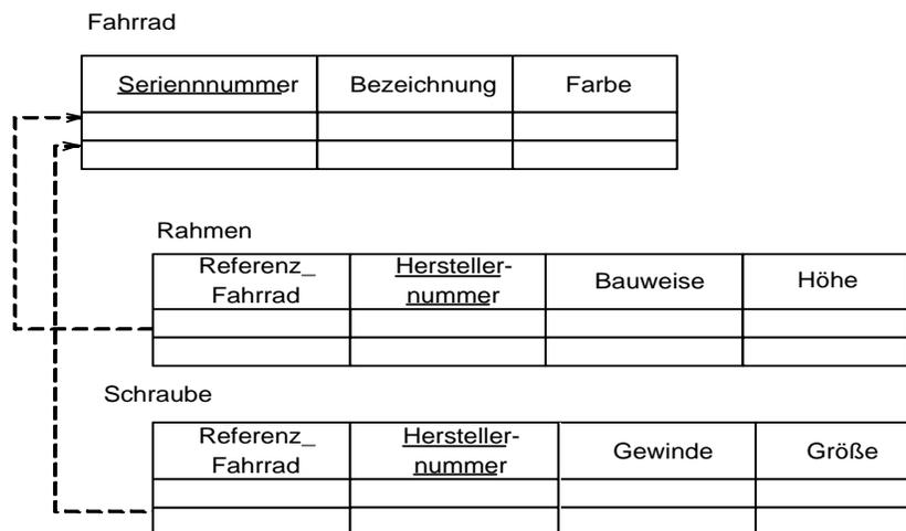
**Abbildung 3.83: Objekt-relationales Modell - Aggregation aufgelöst nach Variante I**
