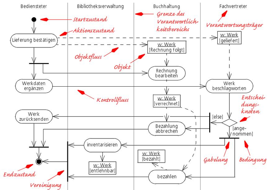
Aktivitätsdiagramme beschreiben in der Regel einen prozeduralen Ablauf und kein ereignisgesteuertes System. Will man dennoch das Senden bzw. Empfangen von Ereignissen oder Signalen modellieren, werden zwei eigene Knotensymbole verwendet.
